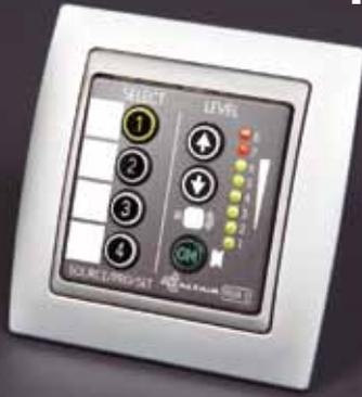
Control remoto para pared basado en RS485 con conexión simple y en cadena permitiendo ajustes de volumen de zona, disparo de presets o selección de fuentes en áreas con personal no técnico. Las funciones asignadas al control así como su acceso son predefinidas por el instalador.
